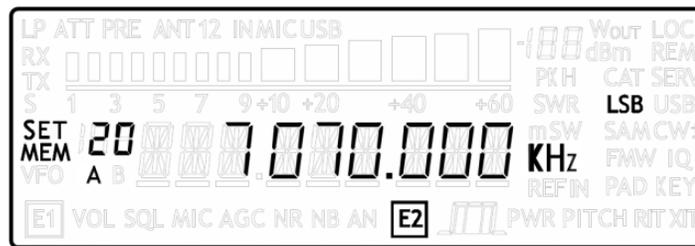
Tournez le bouton E2 pour choisir le canal mémoire et appuyez sur le bouton E2 pour sauvegarder le VFO dans le canal sélectionné.
