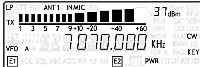
Une fois la fonctionnalité activée l'appareil émet un signal en mode CW à la fréquence affichée sur l'écran. Le bouton E2 peut être utilisé pour régler la puissance de sortie. Le délai d'activité est par défaut de 30 secondes et il peut être modifié dans le menu avancé 49 (TUNE TIME).
