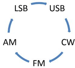
Si le mode FM n'est pas utilisé il peut être désactivé par l'intermédiaire du menu 14 « FM MODE ». L'intérêt principal de cette fonction est de ne pas entendre le bruit gênant de la FM lors du passage sur ce mode pour aller dans un autre mode.
