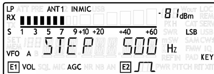
En effectuant « une pression longue » sur le bouton d'accord s'active le menu d'accord chiffre par chiffre. Ce menu permet de modifier la fréquence non pas à l'aide du step mais en agissant directement sur la valeur de chaque chiffre.
