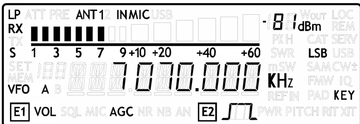
Après quelques secondes de démarrage l'appareil se met en réception sur le VFO sélectionné auparavant, par défaut le VFO A.
